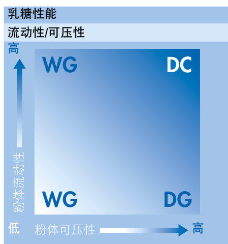
图1：不同压片方法对混合物料可压性和流动性的要求（DC-直压；WG-湿法制粒；DG-干法制粒） [3]。
