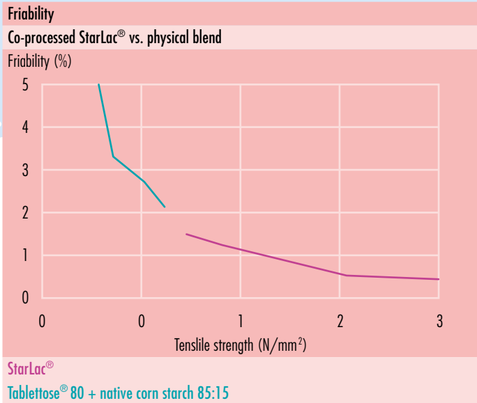
图11: StarLac®或其相应简单物理混合物压片脆碎度。
