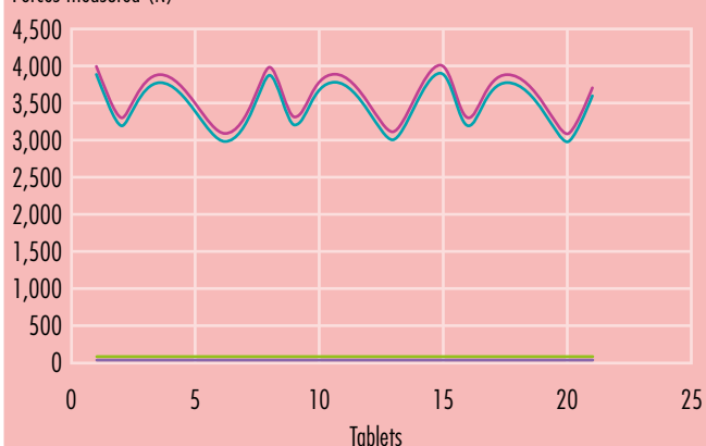
Figura 14: Fuerza de compresión máxima medida por la fuerza superior (púrpura), inferior (verde manzana) de punzón y residual máxima (violeta) y eyección (verde hoja) para comprimidos que contienen el 10% de propranolol HCl preparado por tres métodos diferentes. Los comprimidos basados en Retalac® y la mezcla física mostraron valores generales más bajos en la medición de fuerza, en comparación con la forma granulada en húmedo. No obstante, el Retalac® coprocesado tiene un rendimiento más consistente. Los comprimidos cilíndricos se prepararon mediante una prensa de comprimidos de punzón simple (Korsch EK O; Berlin) utilizando punzones de cara plana.
