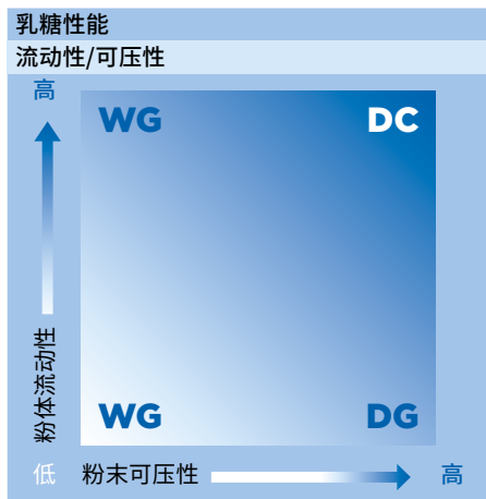
图1: 不同压片方法对粉末混合可压性和流动性的要求 (DC-直压;WG-湿法制粒;DG-干法制粒) [3]。
