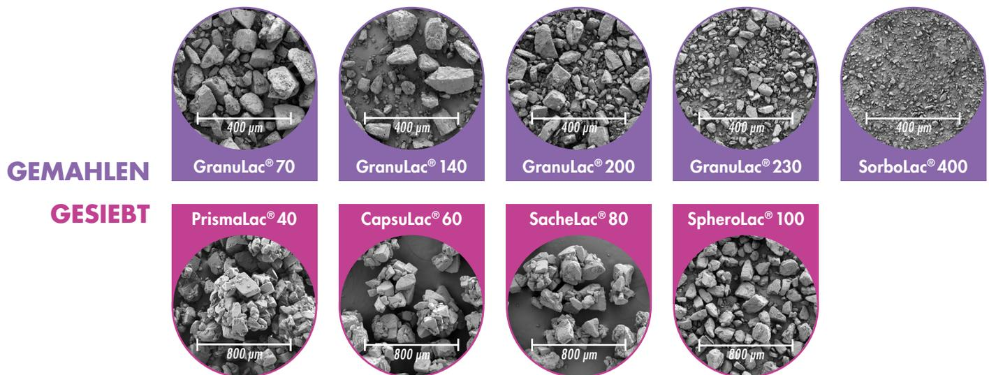
Abbildung 6: REM-Aufnahme der verschiedenen gemahlene und gesiebte MEGGLE Lactosen.
