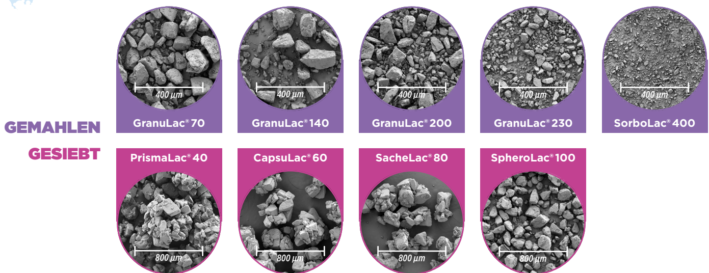
Abbildung 6: REM-Aufnahmen der verschiedenen gemahlene und gesiebte MEGGLE Lactosen. Aufgenommen mit ZEISS Ultra 55 FESEM (U= 5 kV; Au/Pd bedampft).
