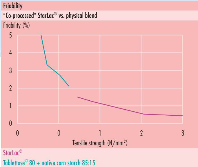
Figure 11 : ici, on montre la friabilité de StarLac® en rapport avec son mélange physique des deux composants.
