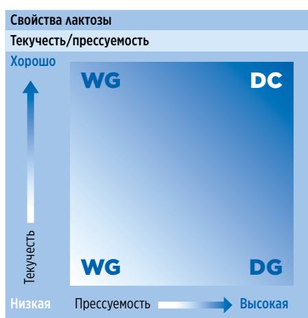
Рисунок 1: Требования к текучести и прессуемости порошков для различных технологических процессов. (DC = Прямое прессование, WG = Влажная грануляция, DG = Сухая грануляция) [3].
