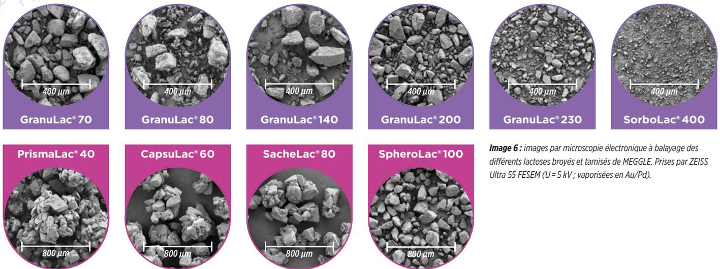
Image 6 : images par microscopie électronique à balayage des différents lactoses broyés et tamisés de MEGGLE. Prises par ZEISS Ultra 55 FESEM (U=5 kV ; vaporisées en Au/Pd).
