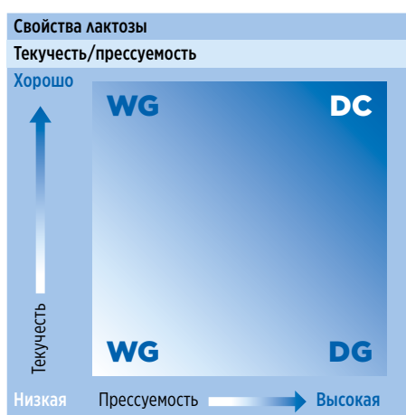
Рисунок 1: Требования к текучести и прессуемости порошков для различных технологических процессов. (DC = Прямое прессование, WG = Влажная грануляция, DG = Сухая грануляция) [3].
