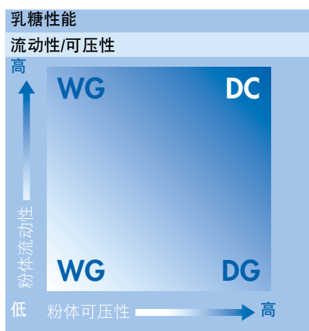
图1：不同压片技术对粉末可压性和流动性的要求（DC-直接压片，WG-湿法制粒，DG-干法制粒） [3]。
