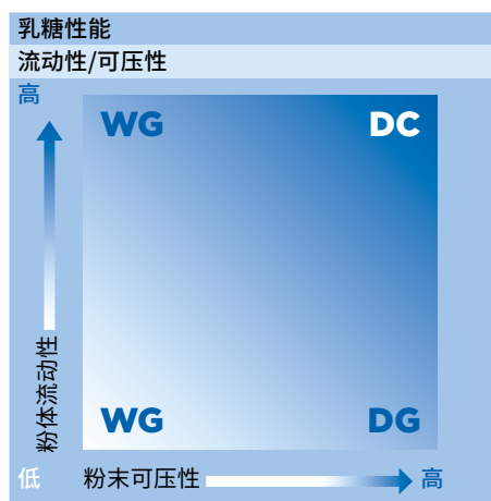
图1: 不同压片方法对粉末混合可压性和流动性的要求 (DC-直压;WG-湿法制粒;DG-干法制粒) [3]。
