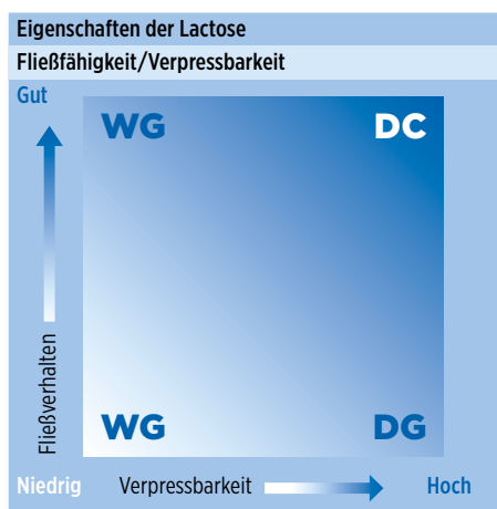
Abbildung 1: Anforderungen an Fließverhalten und Verpressbarkeit einer Pulvermischung unter Berücksichtigung verschiedener Tablettierverfahren. (DC = Direkttablettierung, WG = Nassgranulierung, DG = Trockengranulierung) [3].
