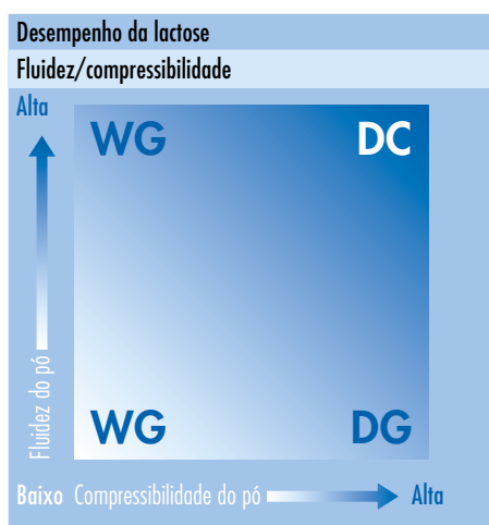
Figura 1: Exigências de fluidez e compressibilidade da mistura de pó para diversas tecnologias de produção de comprimidos (DC é compressão direta, WG é granulação úmida e DG é granulação seca) [3].
